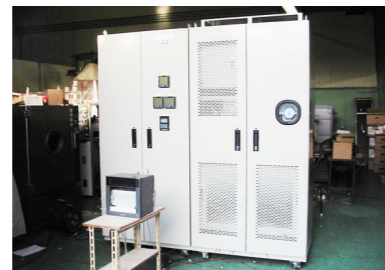
PDU 盤の温度上昇試験状況
